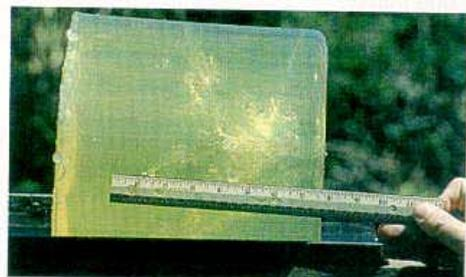
Il blocco di gelatina evidenzia una penetrazione prima dell'inizio dell'espansione e al centro la formazione del cono derivante dalla frammentazione
