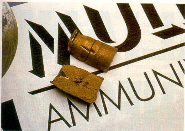
Una palla ESM repertata dopo l'impatto su gelatina: si noti la frattura longitudinale e la divisione in altre due parti della sezione in alto
