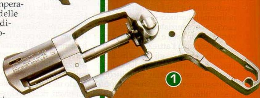
1. Il tipico risultato di un errore di ricarica in un revolver: tamburo "dimezzato" e telaio danneggiato
