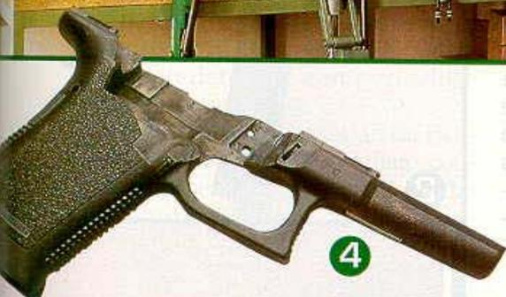
1. In questo caso la ricarica ha detonato anziché bruciare. Nonostante la quantità di propellente non fosse eccessiva il danno è stato spettacolare
