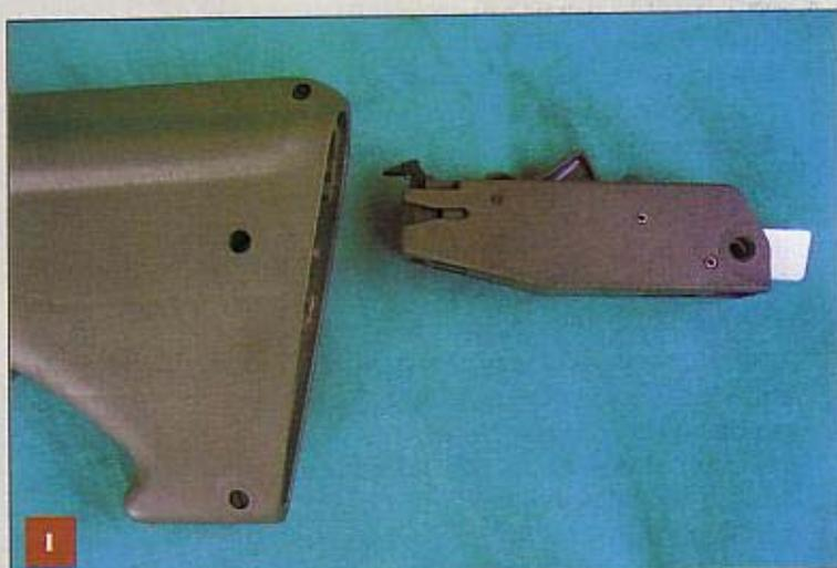
Il pacchetto di scatto si reinsertisce in posizione attraverso un vano nella parte posteriore della calciatura
