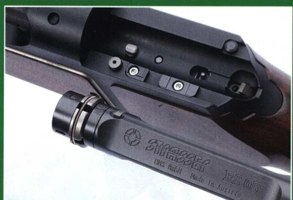
▲ Particolare dell'otturatore; notare gli elementi radiali della sua testa che garantiscono la chiusura dell'arma
