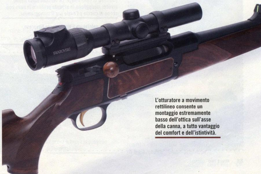
L'otturatore a movimento rettilineo consente un montaggio estremamente basso dell'ottica sull'asse della canna, a tutto vantaggio del comfort e dell'istintività.
