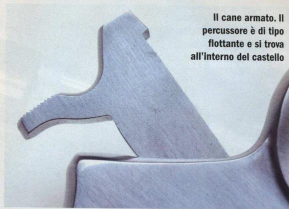
Il cane armato. Il percussore è di tipo flottante e si trova all'interno del castello
