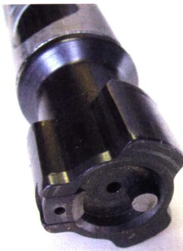
Vista ravvicinata della robusta testa dell'otturatore dotata di tre alette di chiusura
