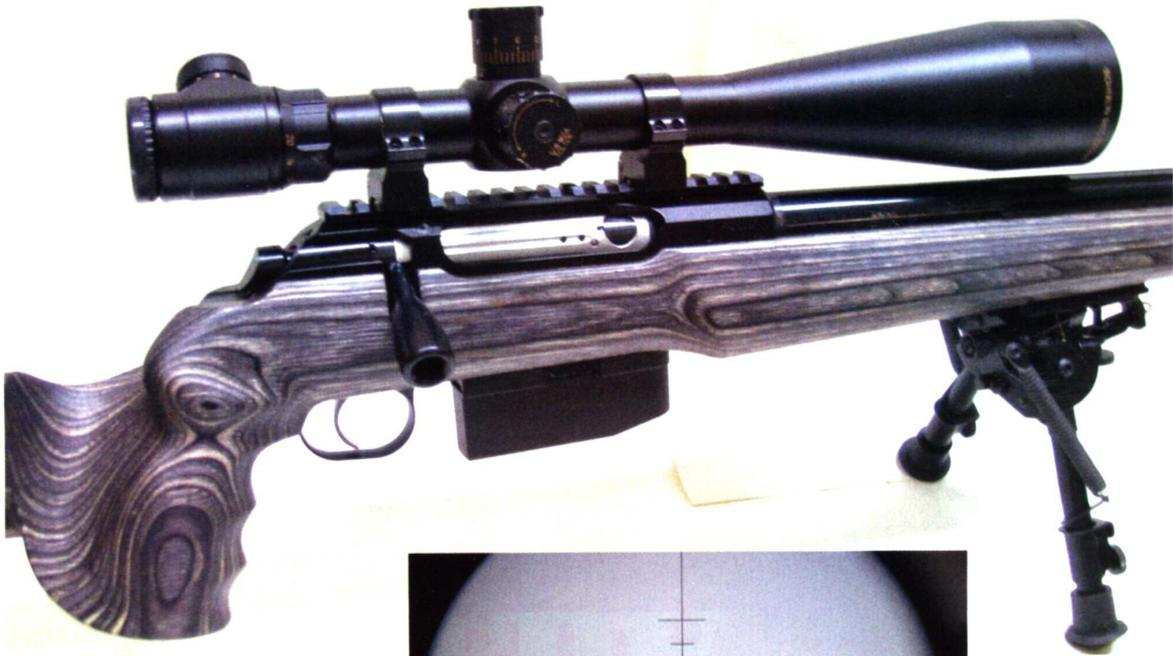
ra è posizionato sul retro del corpo otturatore, e si aziona con facilità. Premendolo esso arretra bloccando lo scatto, l'apertura dell'otturatore e scopre una tacca bianca di riferimento. Per ripristinare la funzionalità basta spingere in avanti il pulsante, e il sistema è armato e pronto al fuoco. Da segnalare che queste operazioni non causano alcun rumore meccanico, un dettaglio forse
